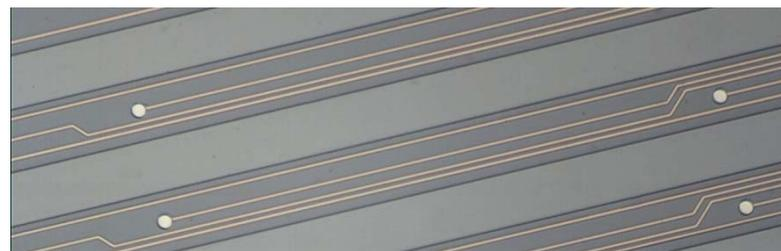
新型电极纵向电极间距达1mm
